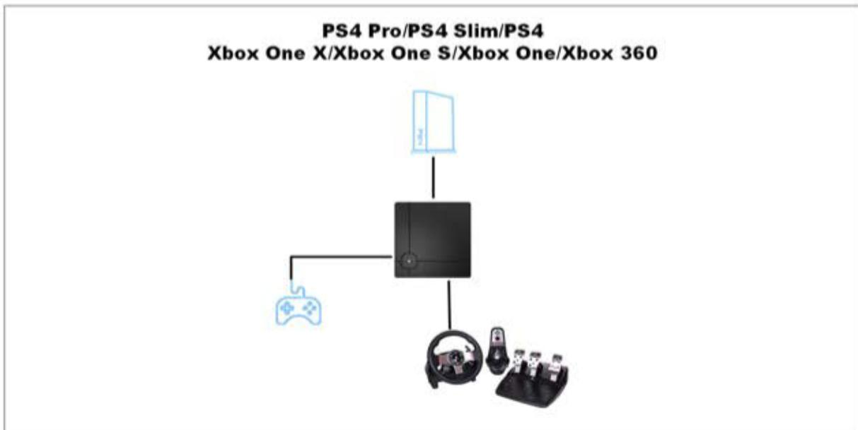
Сперва подключите к ReaSnow S1 оригинальный контроллер в порт USB1 и руль в порт USB2 или USB3, а затем подключите S1 к консоли.
